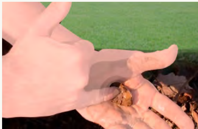
Figura 28: Teste de fita e textura. Fonte: Adaptado a partir de Groit Buildit, 2020.
