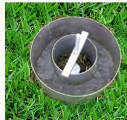
Figura 37: Superior: Peças componentes de um infiltrômetro de anel duplo. Fonte: Adaptado a partir de Virtual Expo Group, c2023, p. 1. Inferior: Infiltrômetro e duplo anel em operação. Fonte: Adaptado a partir de UPV, 2016.
